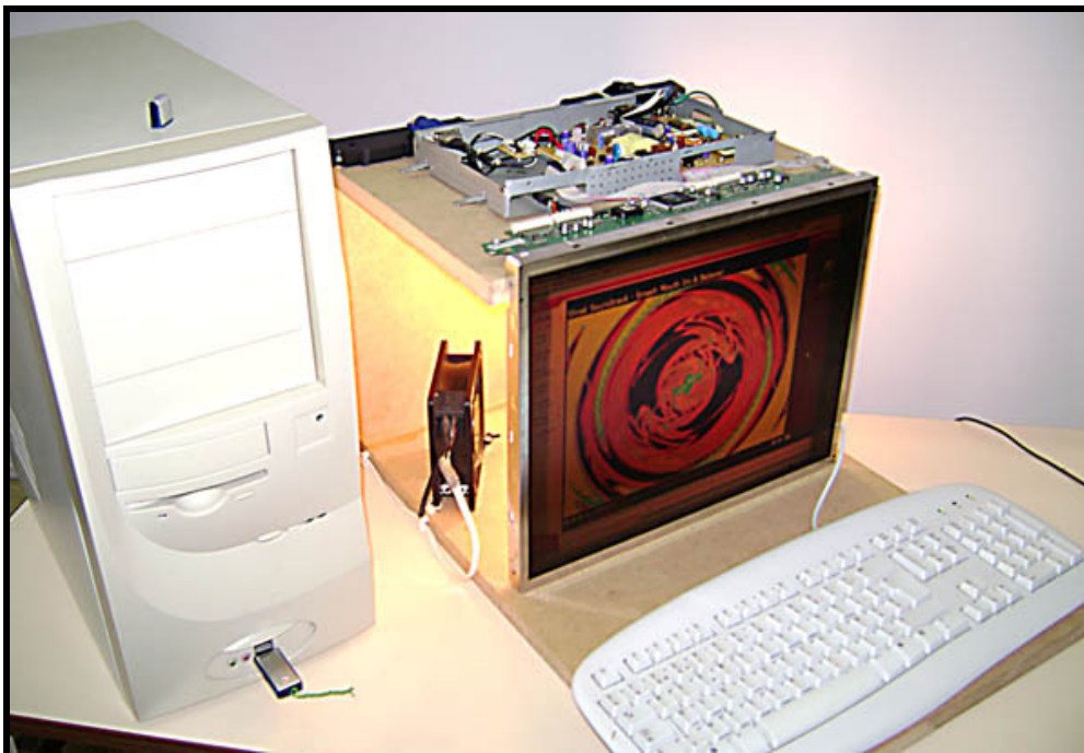
Figuur: het afgewerkte project, met het defecte LCD-TFT scherm in werking. Links zie je de ventilator om het beeldscherm te koelen (dit is nodig door de 60 Watt lamp die zich achter het scherm bevindt)
